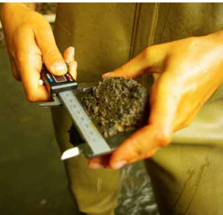
Mesure du diamètre des granulats présents dans le cours d'eau
