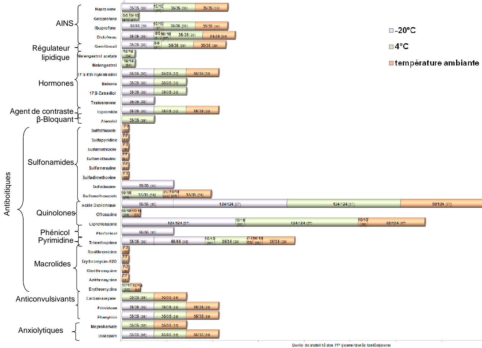
Figure 2 : Durée de stabilité des RP dans les eaux de surface en fonction de la température de stockage
