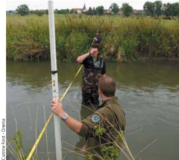
Mesures des caractéristiques hydromorphologiques d'un cours d'eau selon le protocole Carhyce : mesure de la hauteur des berges à l'aide d'un clisimètre.
